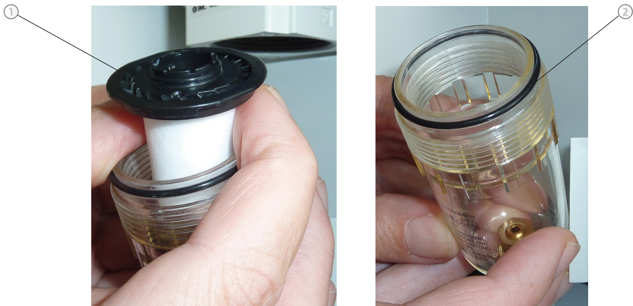
Fig. 4 - 5 Support de l'élément filtre enlevé
